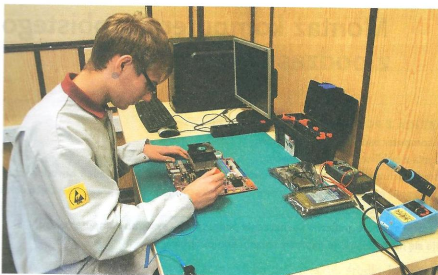
Rys. 42.1. Przykładowe szkolne stanowisko montersko-diagnostyczne
